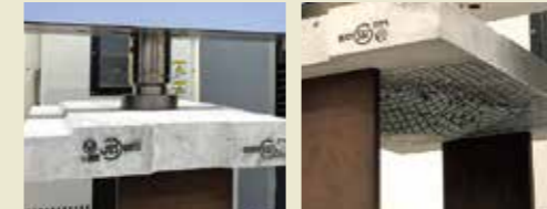
コンクリート試験体が押し抜きされている様子
