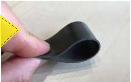
塗膜が有機質と無機質の結合体であるため、熱や寒さによる影響が少なく、温度変化抵抗性があります。また、適度な伸び弾性および引張強度があるため床版・アスファルト舗装の挙動に一体化的に追従します。そのため、荷重負荷による防水層の損傷・欠陥が発生しにくくなります。
