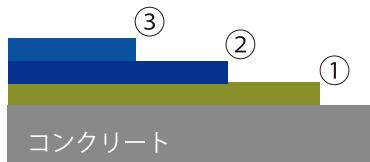
橋梁の床版防水工の場合は、工程終了後③にアスファルト舗装を施工します。
